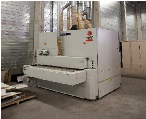
Het schrapen/schuren van de bestaande topbladen, komende uit het renovatieproject
