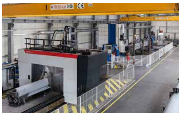
Telemond | Gerobotiseerde laslijn voor telescopische giek
